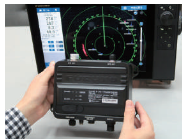
↑ AIS 本体。正面はレーダー指示部で、画面上に受信した AIS 信号を表示しています。
