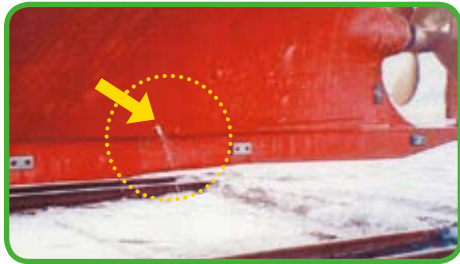
②配管の腐食
